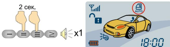
Смена режимов работы происходит длительным двухсекундным нажатием кнопок II+III брелока-коммуникатора в следующем порядке: (функция включена, режим 1) > (функция включена режим 2) > (функция выключена) > (функция включена, режим 1) и т. д.
