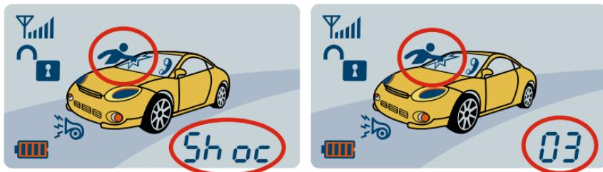
Если в режиме охраны система срабатывала только от датчика вызова владельца, то при снятии с охраны система сообщит об этом миганием символа «CALL» и указанием числа срабатываний.
